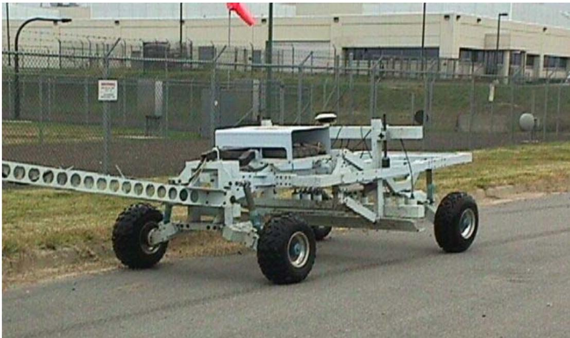
Figure D-7. MTADS Magnetometer Array
