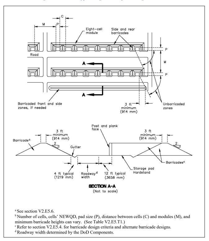
Figure V2.E5.F3. Typical Eight-Cell Open Storage Module<sup>a,b</sup>
