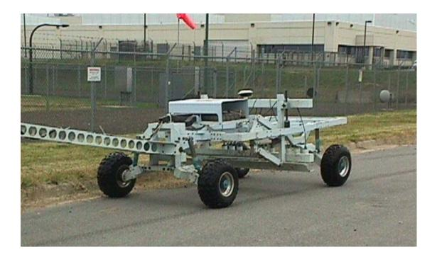
Figure D-7. MTADS Magnetometer Array
